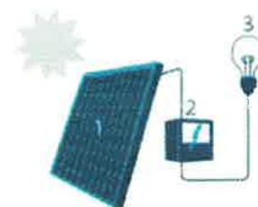
1. Zonnepaneel | 2. Omvormer | 3. Elektrische aansluiting
